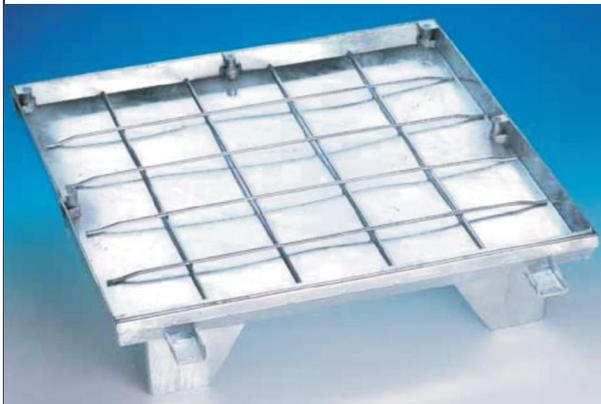
**Anwendungsempfehlung:** Für Schächte die häufig und ohne besondere Kraftanstrengung geöffnet werden sollen. Speziell für Inspektions- und Revisionsschächte. Ideal für Schwimmbadschächte (BVE-GD Edelstahl) da für die wöchentliche Wartung das Öffnen und Schließen des Schachtes ohne nennenswerte Kraftanstrengung durchgeführt werden kann. Bei Indoor-Schwimmbädern nur Material 1.4571 (V4A) verwenden!
