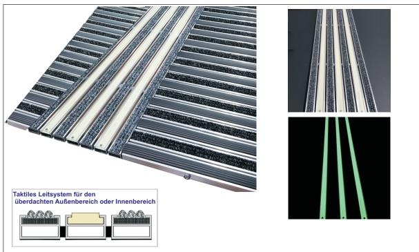
Bei fachgerechtem Einbau und vollflächiger Auflage der Matte auf dem Untergrund, trägt die Matte eine ruhende (verteilte) Last von mind. 1850 kg./ 100cm². Für starke bis sehr starke Fußgänger Frequentierung geeignet. Überrollbar mit Einkaufswagen, Rollstuhl, Kinderwagen und Transportkarren mit Luftbereifung und Rädern die mind. einen Ø von 20 cm aufweisen.
