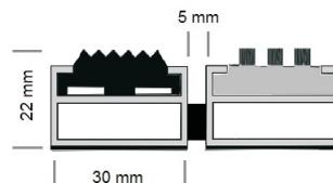
Eingelassene, widerstandsfähige, witterungsbeständige und gerillte Kunststoff-Einlage im Wechsel mit dreireihiger Polyamidbürstenleiste.
