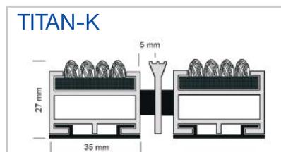
Eingelassene, widerstandsfähige, witterungsbeständige und gerillte Rauhaarris-Einlage im Wechsel mit Alu-Kratzkante zur Erhöhung des Schmutzabriebs.
