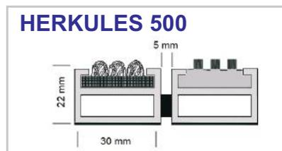
Eingelassene, widerstandsfähige, witterungsbeständige und gerillte Rauhaarrips-Einlage im Wechsel mit gerillte Kunststoff-Einlage. Brandschutzklasse B2 nach DIN 4102.
