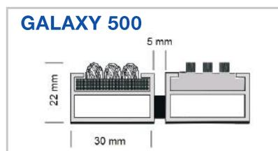
Eingelassene, widerstandsfähige, witterungsbeständige und gerillte Rauhaarrrips-Einlage im Wechsel mit dreireihiger Polyamidbürstenleiste. Durchmesser der Bürstenbündel 4 mm. Brandschutzklasse B2 nach DIN 4102.
