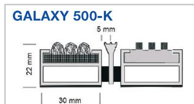
Eingelassene, widerstandsfähige, witterungsbeständige und gerillte Rauhaarrips-Einlage im Wechsel mit dreireihiger Polyamidbürstenleiste im Wechsel mit Alu-Kratzkante zur Erhöhung des Schmutzabriebs. Durchmesser der Bürstenbündel 4 mm. Brandschutzklasse B2 nach DIN 4102. (Brandschutzklasse Rauhaarrips-Einlage B1 möglich.)
