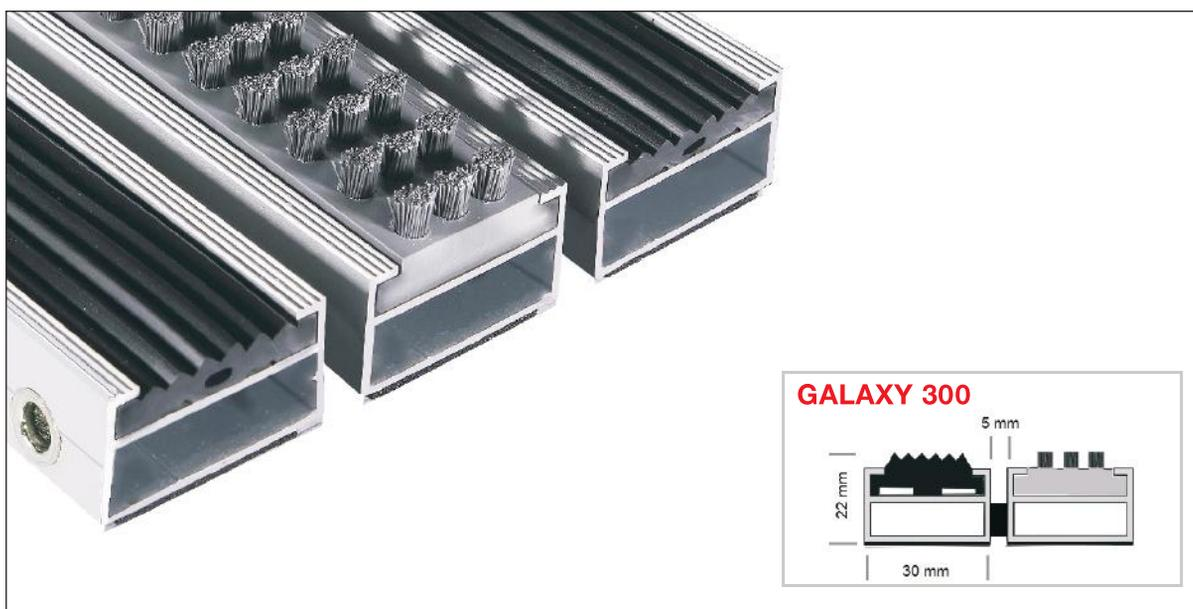
Eingelassene, widerstandsfähige, witterungsbeständige und gerillte Kunststoff-Einlage im Wechsel mit dreireihiger Polyamidbürstenleiste. Durchmesser der Bürstenbündel 4 mm. Brennkategorie B2 nach DIN 4102.
