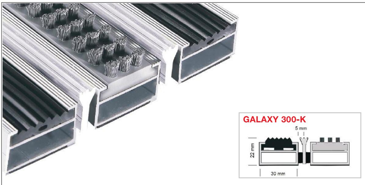
Eingelassene, widerstandsfähige, witterungsbeständige und gerillte Kunststoff-Einlage im Wechsel mit dreireihiger Polyamidbürstenleiste. Zusätzlich mit Alu-Kratzkante zur Erhöhung des Schmutzabriebs. Durchmesser der Bürstenbündel 4 mm. Brennklasse B2 nach DIN 4102.
