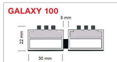
3-reihig eingelassene widerstandsfähige und witterungsbeständige PVC/Polyamidbürstenleiste. Durchmesser der Bürstenbündel 4 mm. Brennkategorie B2 nach DIN 4102.
