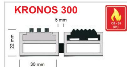
Eingelassene, widerstandsfähige,witterungsbeständige und gerillte Kunststoff-Einlage im Wechsel mit dreireihiger Polyamidbürstenleiste. Durchmesser der Bürstenbündel 4 mm.
