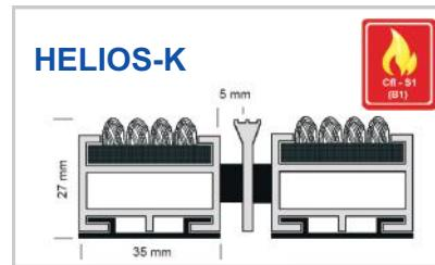
Eingelassene, widerstandsfähige, witterungsbeständige und gerillte Rauhhaarribs-Einlage im Wechsel mit Alu-Kratzkante zur Erhöhung des Schmutzabtriebs.
