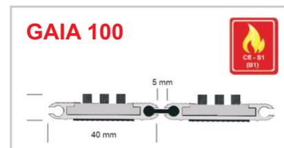
3-reihig eingelassene widerstandsfähige und witterungsbeständige PVC/Polyamidbürstenleiste. Durchmesser der Bürstenbündel 4 mm.
