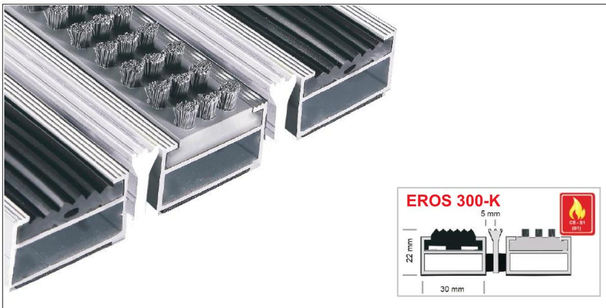
Eingelassene, widerstandsfähige, witterungsbeständige und gerillte Kunststoff-Einlage im Wechsel mit dreireihiger Polyamidbürstenleiste. Zusätzlich mit Alu-Kratzkante zur Erhöhung des Schmutzabriebs. Durchmesser der Bürstenbündel 4 mm.
