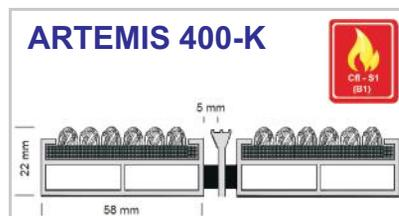
Eingelassene, widerstandsfähige, witterungsbeständige und gerillte Rauhaarrisps-Einlage im Wechsel mit Alu-Kratzkante zur Erhöhung des Schmutzabriebs.
